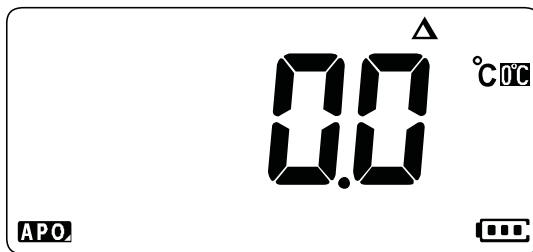
图 2-21 没有环境补偿的温度测量
